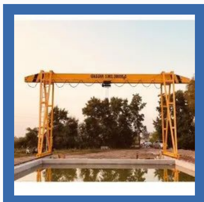
3 Ton Gantry Crane
